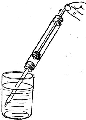
En tirant le piston vers le haut, l'eau pénètre dans le tube, parce que la pression de l'air qui se manifeste sur la surface libre de l'eau la pousse dans le tube où la pression est nulle. Ouvrons la fenêtre, dirigeons
