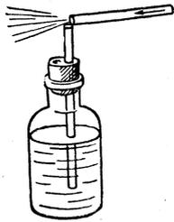
C'est un appareil des plus simples : un tube droit, effilé, dont l'extrémité inférieure plonge dans l'eau, puis un deuxième tube tenu horizontalement, tout près de l'orifice du tube effilé, et dans lequel on souffle. Le courant d'air qui passe sur le tube effilé fait monter l'eau qui est en quelque sorte aspirée de la bouteille.
